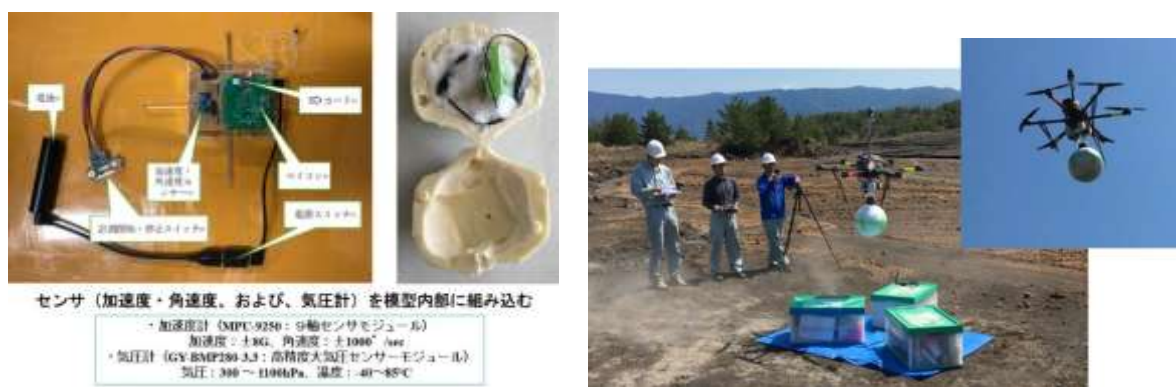
(左) 噴石の落下性状を調べるために行われた落下実験において使用された噴石模型に組み込まれたセンサー類、(右) ドローンによる模型のつり上げと落下実験の様子。
